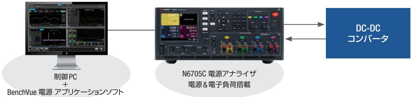
入力電圧を変えながら、負荷電流を変化させ、その時の入力パワーと出力パワーを測定を繰り返すDC-DCコンバータの効率測定こそ、自動化での大きなメリットが得られます。BenchVueのテストフローを用いれば最小限のプログラム、測定器の知識で自動テストシーケンスをすばやく作成できます。
