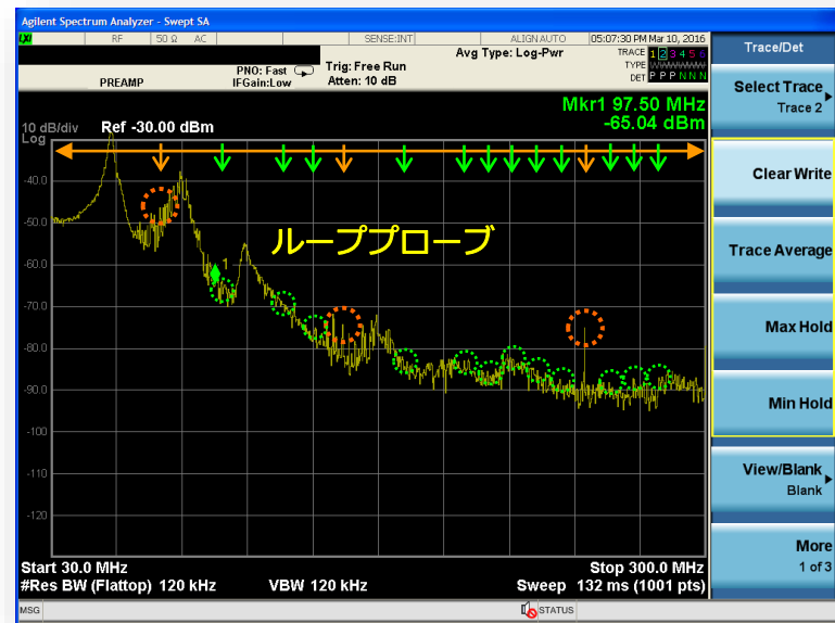
ループアンテナで電源部を測定した結果
