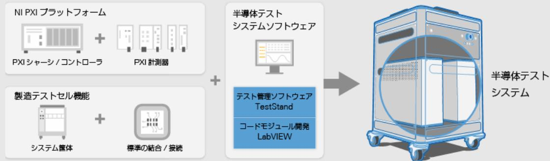
PXIがシステム筐体に組み込まれた、PXIベースのATEソリューション
