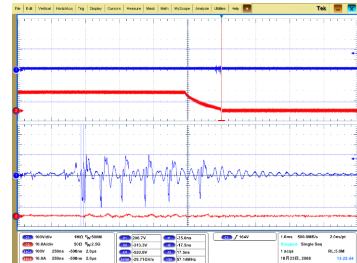
Turn-OFF時 サージ電圧：約520Vp-p
