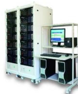
充放電試験装置
