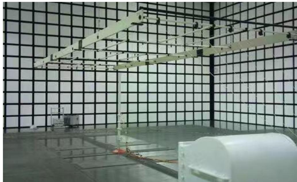
※電波暗室とは、周囲の電波環境に影響されないように、外部からの電磁波を遮断し、かつ外部に電磁波を漏らさず、さらに内部で電磁波が反射しないように設計・施工されたシールド空間のことです。センサーの性能試験やEMC計測などに使用する特殊な実験室です。
