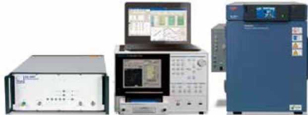
また、自動車の電動化に欠かせないバッテリー電圧を昇圧するコンバータには、昇圧用リラクトルが使用されます。昇圧用リラクトルには、交流電流だけでなく大きな直流電流も流れるため、磁気飽和しにくい軟磁性材料を使用する必要があります。適切な軟磁性材料評価には交流と直流の電流を同時に印加可能な磁気特性測定システムが必要です。
