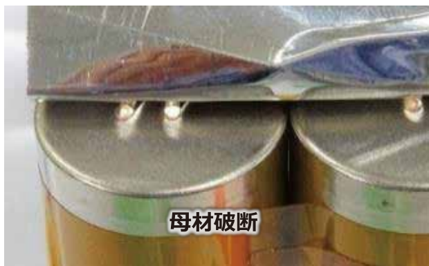
溶接後強制剥離
