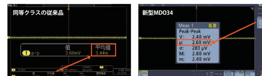
新開発の高性能アンプを搭載、従来比20%以上の低ノイズを実現
